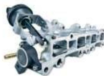
mehr. Gemeinsam mit Volkswagen entwickelten wir das System, und übernahmen Entwicklung, Prototyping, Giessen, Bearbeitung, Montage und Prüfung. Jetzt kommt die Ansauganlage des FSI einbaufertig als Komplettsystem von Handtmann. Und an den FSI-Motor kommt eine Ansaugtechnik, die bei reduziertem Verbrauch verblüffend hohe Leistung möglich macht. Da dürfte so manchem Wettbewerb der Atem stocken.
