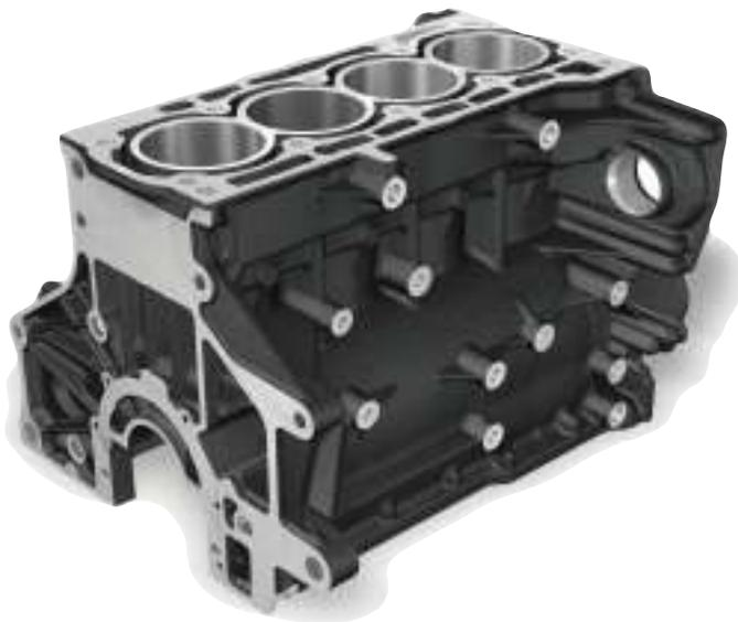
**Bild 5:** Zylinderkurbelgehäuse
