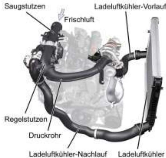
**Bild 24:** Luftführende Bauteile
