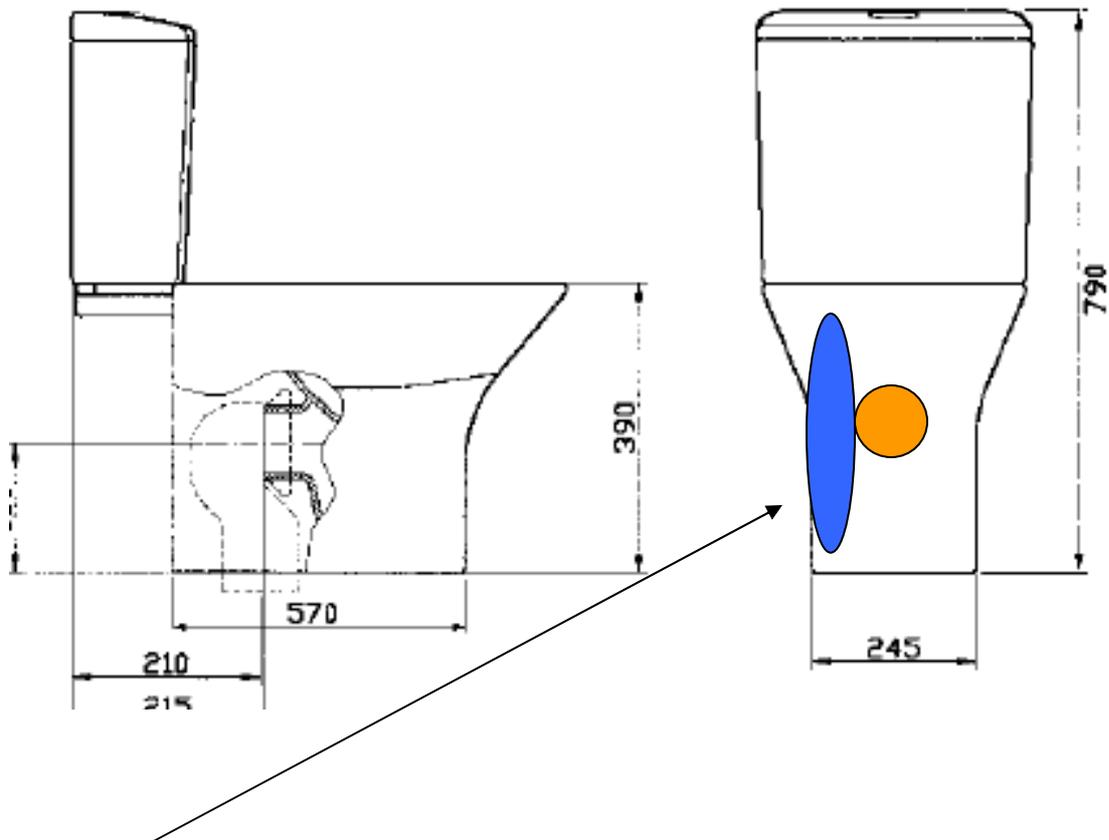
Der Anschluss des Nexo - Spülkastens kann lt. Information unserer techn. Abteilung im Bereich der blauen Markierung untergebracht werden. Es ist nur zu beachten, dass der Anschluss **nicht** sichtbar ausgeführt wird.
