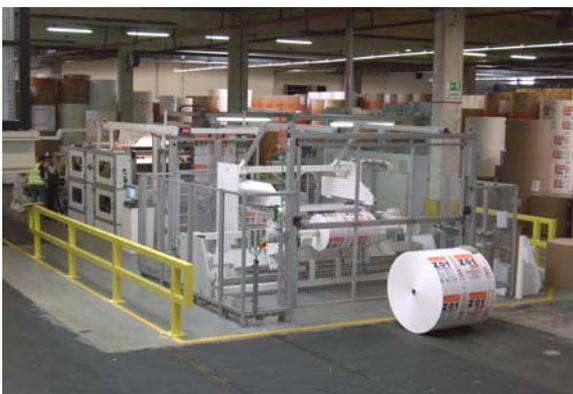
Durch modulare Bauweise können die Druckeinheiten übereinander bzw. hintereinander kombiniert werden. Vorder- und Rückseitendruck sind möglich.
