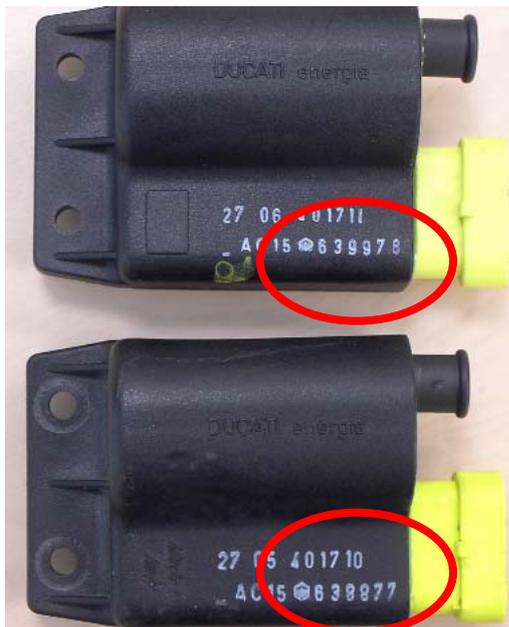
Ducati CDI aus dem Umrüstkit, Ersatzteilnummer 639978, darf nur in Verbindung mit einem Ducati Spannungsregler verbaut werden.
