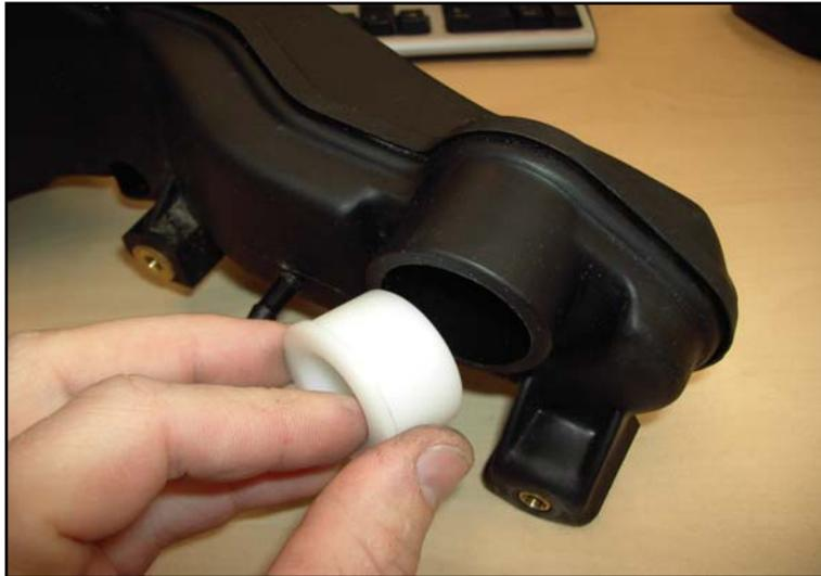
Zur Verjüngung des Ansaugdurchmessers, wird die Reduzierhülse von der Rückseite in den Luftfilterkasten eingesetzt
