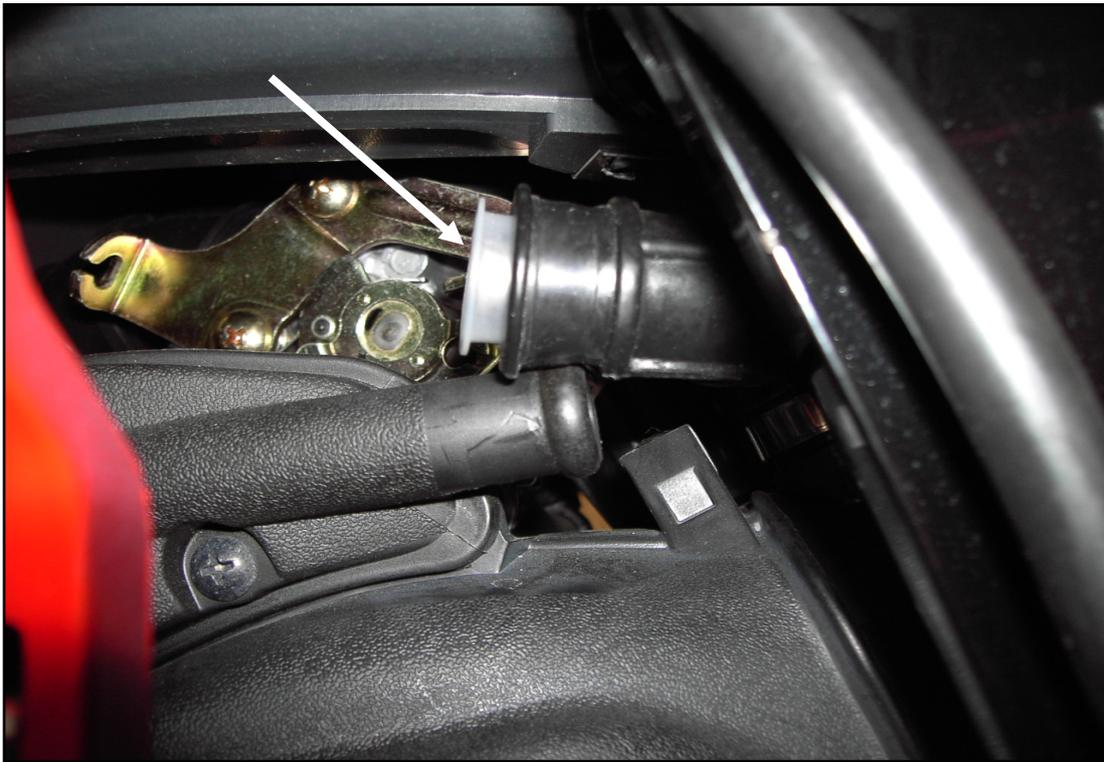
Nehmen Sie die Abgaskontrolle bei betriebswarmem Motor vor. Um die Abgaswerte zu kontrollieren, **muss** die Sekundärluftzufuhr abgeklemmt werden. Dazu nehmen Sie den Gummistutzen der Sekundärluftzuführung vom Vorfilter ab und verschließen diesen.
