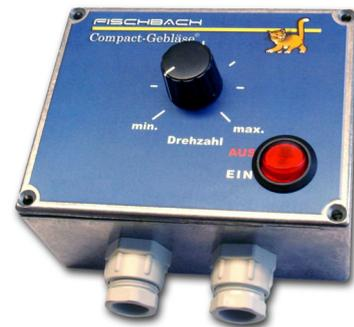
**Wichtig:** Wenn die Motortemperatur über 130°C ansteigt, schaltet der im Motor eingebaute Thermokontakt den Drehzahlsteller ab. Bitte ermitteln und beheben Sie die Fehlerursache vor Wiederinbetriebnahme, um Folgeschäden zu vermeiden.
