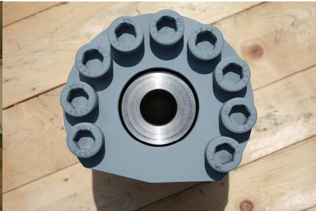
Pressenzylinder Kolbendurchmesser 400mm
