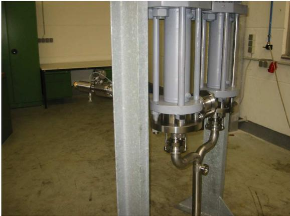
Pressenzylinder Kolbendurchmesser 320mm
