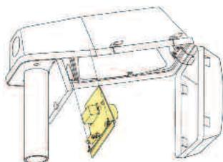
Herausnehmbarer Geräteträger, mit allen elektrischen Komponenten
